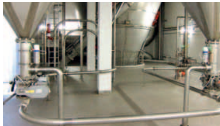
Filtres AAIRMAXX® ESP avec écluses de décharge et tuyaux pour le transport des poudres
